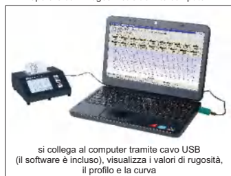
operare con il rugosimetro tramite computer
