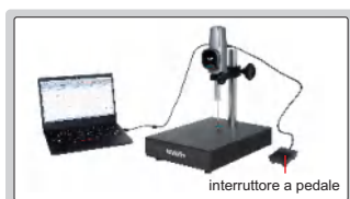
interruttore a pedale dati trasmessi a Excel senza software; premere brevemente l'interruttore a pedale per trasmettere i dati, premere a lungo per azzerarli
