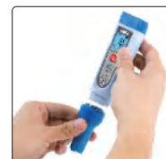
gli elettrodi possono essere sostituiti
