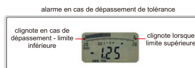
alarme en cas de dépassement de tolérance
