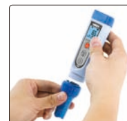
les électrodes peuvent être remplacées
