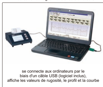
utilisation du rugosimètre avec ordinateurs
