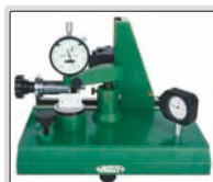
vérifier la répétabilité des indicateurs à cadran
